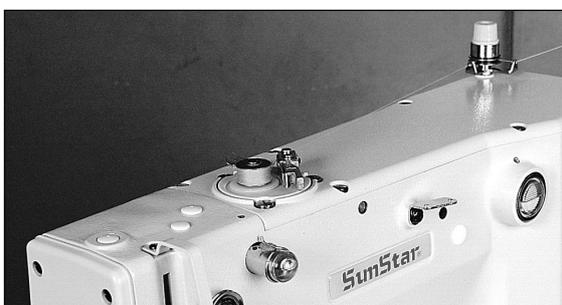
Passa a linha conforme mostrado na figura e enrole a linha inferior.
